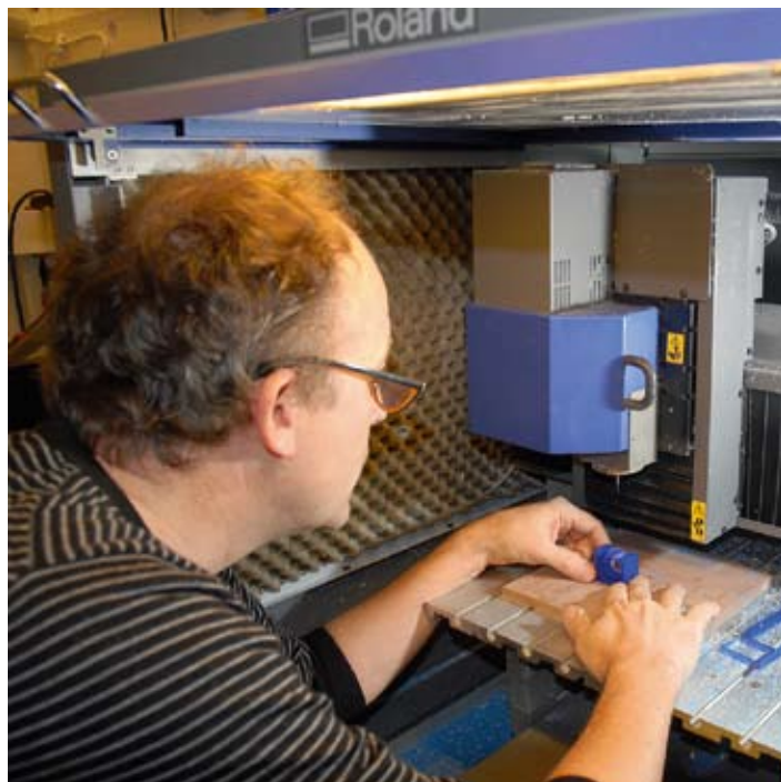
I værkstedet er der også en fræser, der med stor præcision fræser forme til støbning af smykker i de mange forskellige materialer, som Kim Buck arbejder med.
