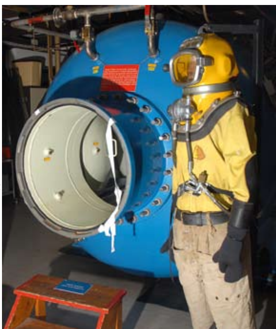
Indgangen til trykkammeret som står i en af bygningerne på skolen
