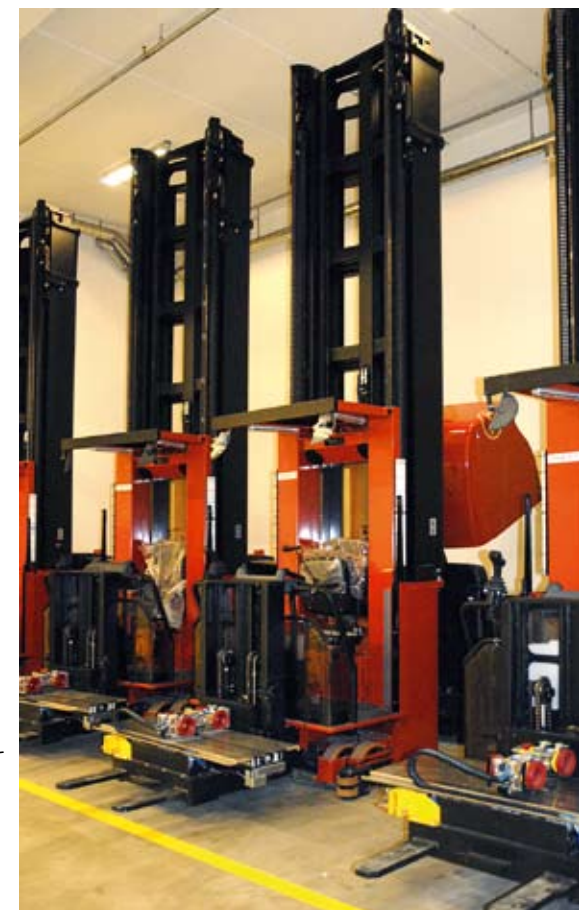
De store "plukke-trucks" der kan køres op, så man kan nå de øverste hylder i 12 meters højde.
