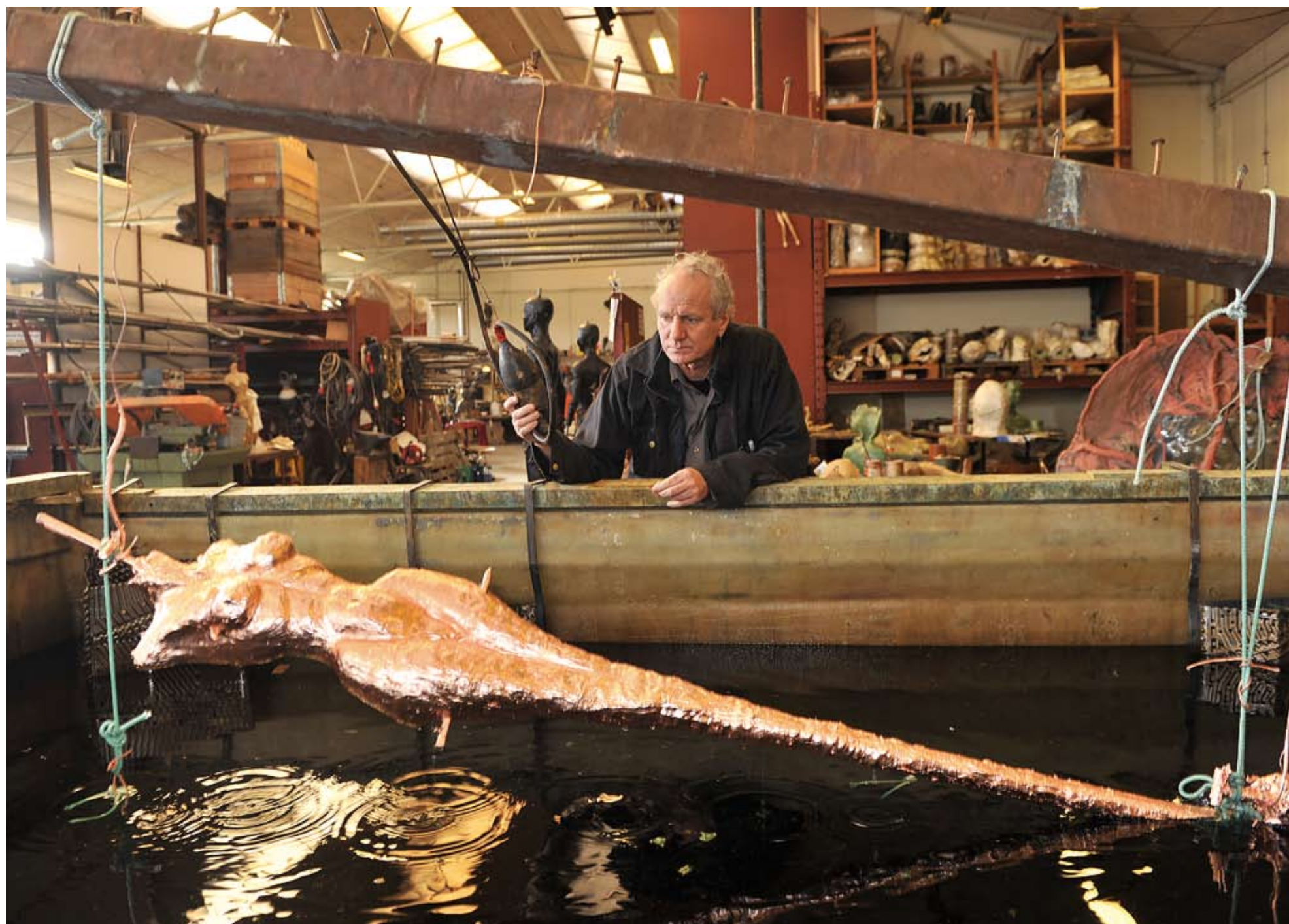
Jens Galschiøt er her ved det store elektrolysekar, hvor en stor figur bliver belagt med kobber, som skal kontrolleres for kvaliteten af kobberbelægningen.
