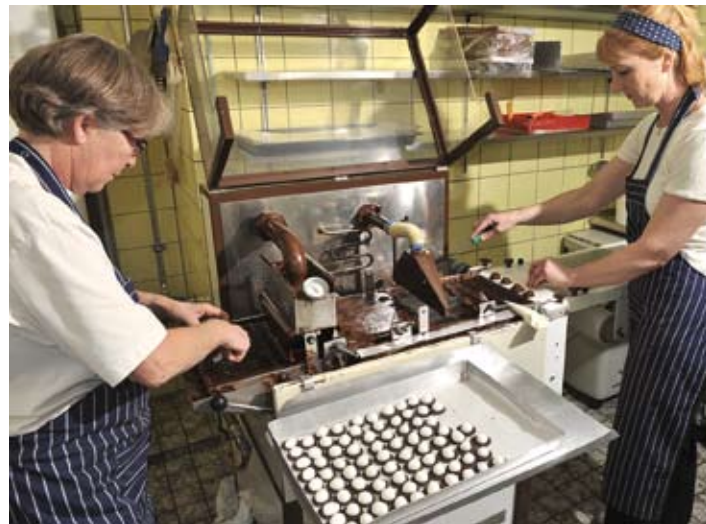
Chokoladeovertræksmaskinen er et vigtigt stykke værktøj til at lave de mange chokoladestykker.
