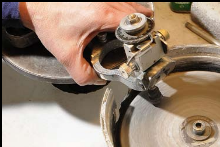
Stenen spændes fast i en grip og føres ned mod den roterende slibeskrive.
