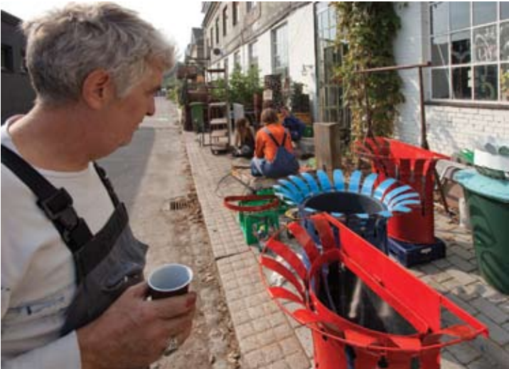
Niels Worsøe, manden bag initiativet, laver affaldskurvene af brugte olietønder. Økologisk og energibesparende genbrug med andre ord. De laves også til ophængning på vægge, med en halvcirkel som grundform.
