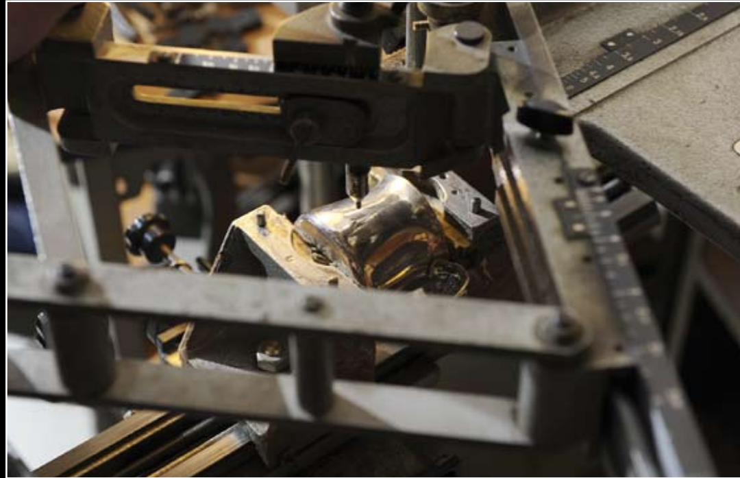
Det hænder, at Kurt maskingraverer, men det er hovedsagelig præmier og den slags. Her ses graveringsapparatet hvor graveringen styres af skabeloner.
