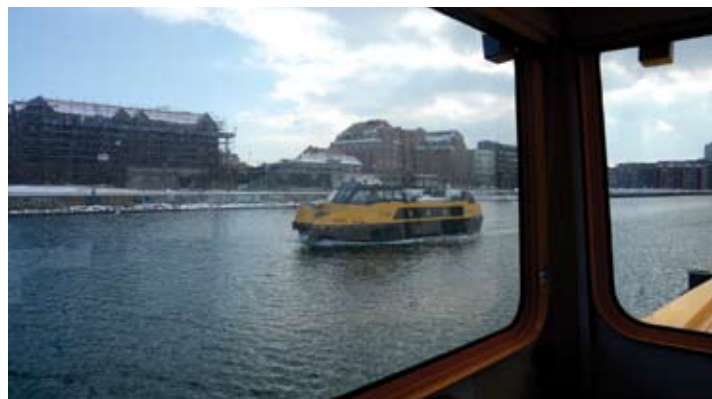
Havnebussens specielle lette konstruktion med en propel i hver ende gør den meget manøvreduktig i smalt farvand
