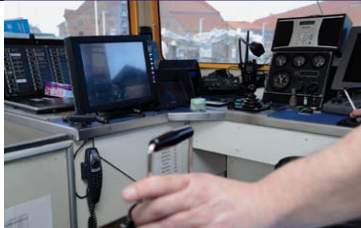
På kommandobroen er alt det tekniske udstyr, der er nødvendigt. Bl.a. VHF-radio, både stationær og håndholdt, så skibsførerne altid kan have fuld forbindelse til kanal 16, som har forbindelse til alarmcentralen.
