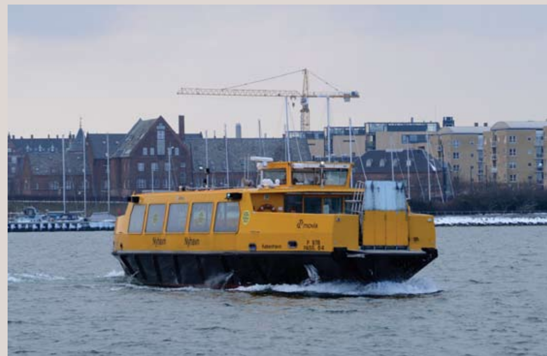
Havnebusen ”Nyhavn”, Total længde: 22,9 m, Bredde: 6,8 m, Siddeplads til passagerer: 64 à 80 kg, Ståplads til passagerer: 20 à 80 kg, Rullestole: 4 à 100 kg, Cykler: 16, Brændstof: 2.000 l, Ferskvand: 1.000 l, 2 dieselmotorer à 102 kw, Max. fart: 9 knob
