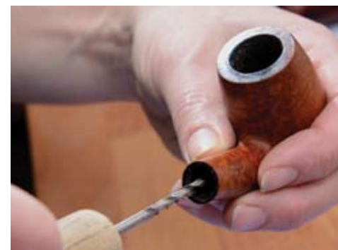
Røgkanalen bores forsigtigt ud
