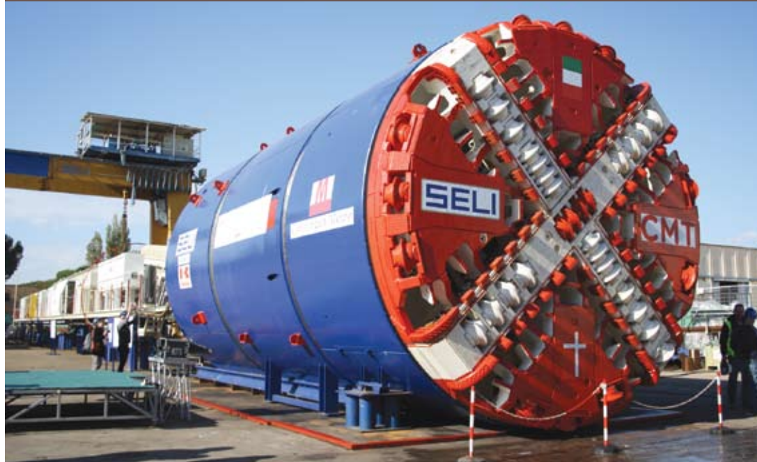
Tunnelboremaskinen fra den italienske entreprenør SELI er 100 meter lang og vejer 130 tons
