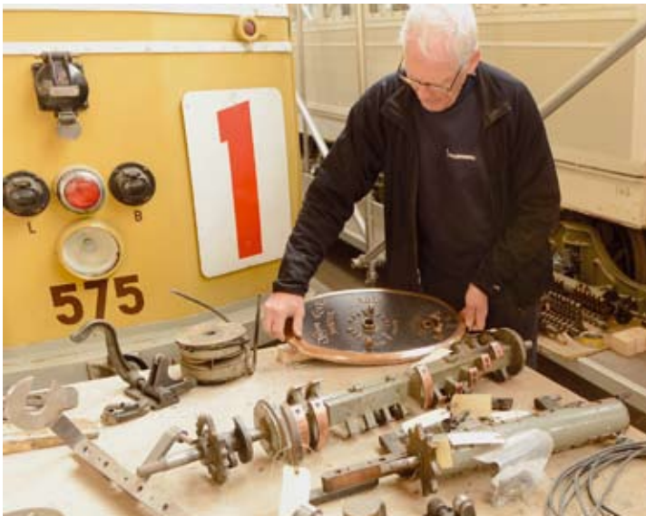
Klaus Thomsen viser strømfordeleren, der styrer hastighed og elektrisk bremse.
