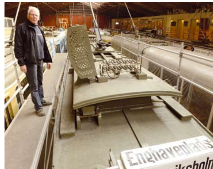
Klaus Thomsen viser den elektriske konstruktion og fine istandsættelse på taget af en vogn
