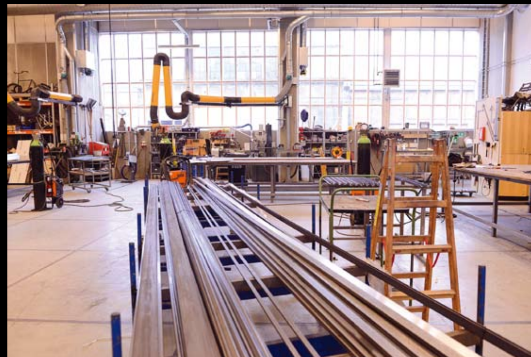
I smedeværkstedet går 5-6 smede. Mange dekorationselementer er meget store og høje og skal kunne tåle at blive kravlet på og blive flyttet ud og ind af sceneteknikere på scenen, så de skal både være stærke og lette på én gang. Derfor arbejdes der meget i aluminium, som beklædes med kanalplast, og udenpå igen kommer der malet lærred.
