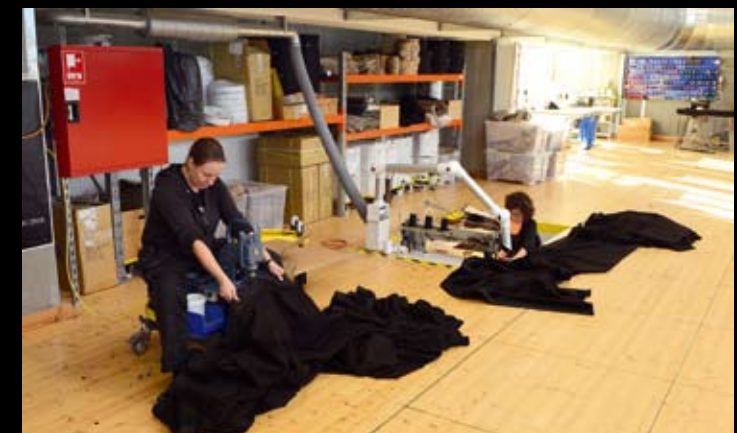
Store tæpper kan sys i gulvhøjde, symaskinen kan sænkes ned i gulvhøjde
